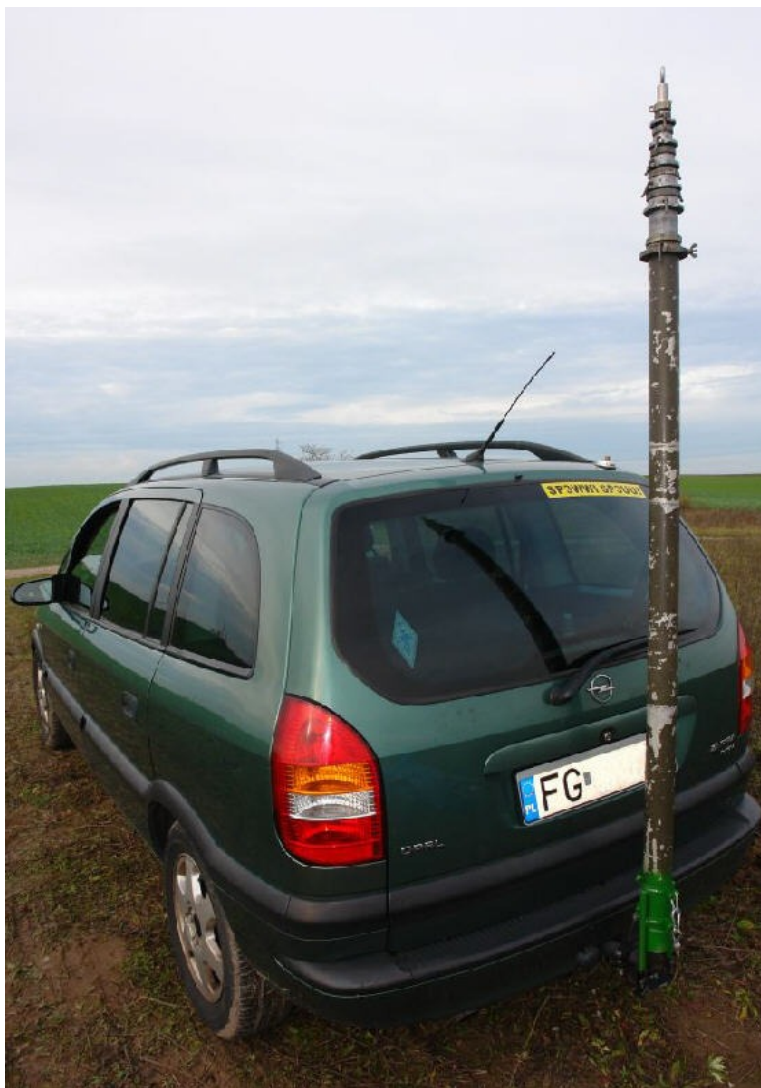
Ilustracja 5: Maszt zamontowany na haku samochodu Opel Zafira.
