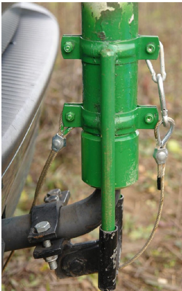
Ilustracja 4: Mocowanie masztu na haku holowniczym.
