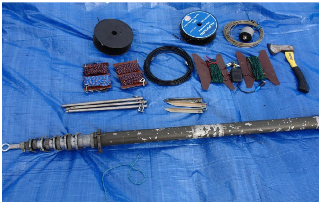
Ilustracja 3: Maszt, dipol, odciąg, akcesoria do montażu.
